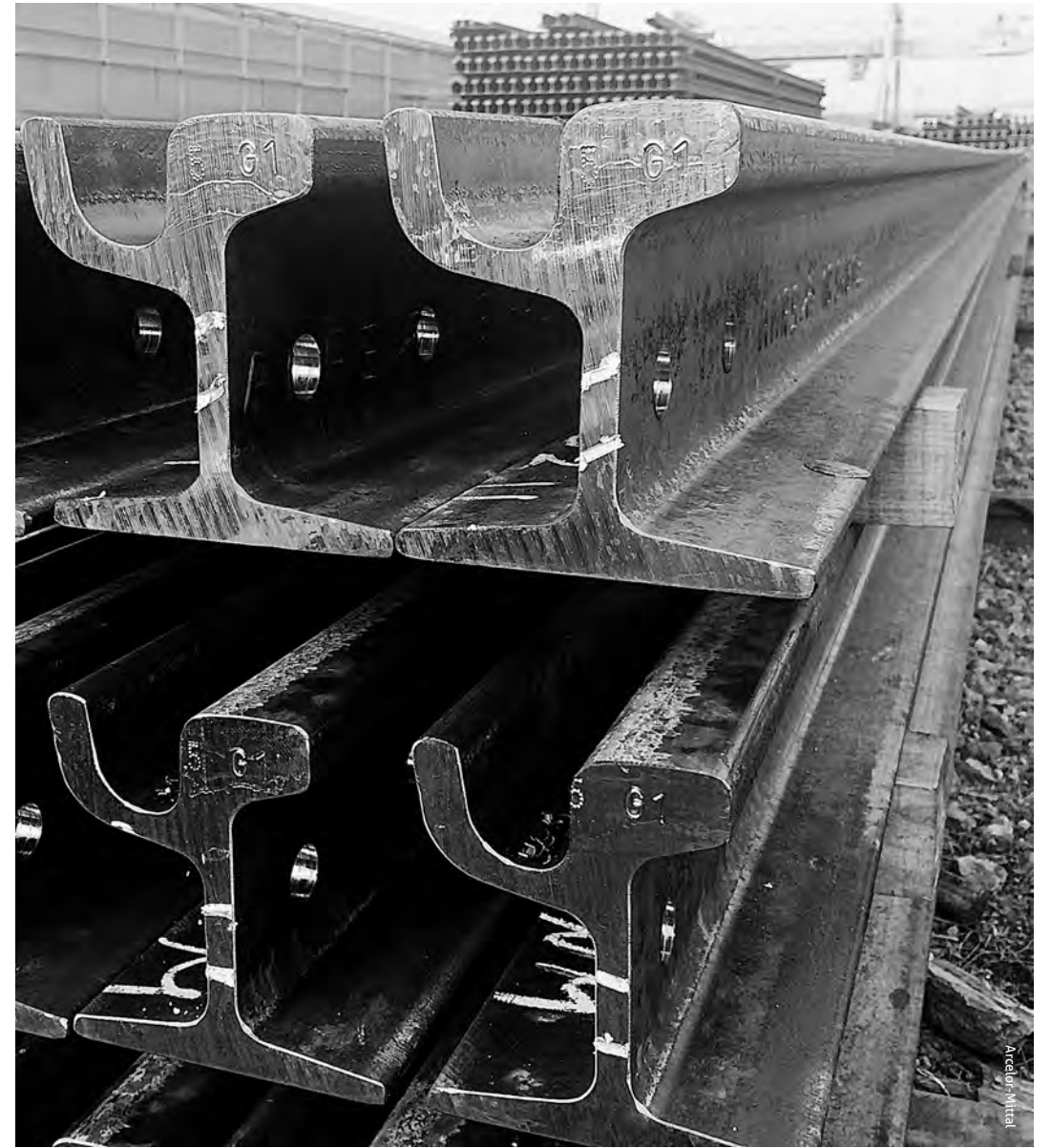
Rillenschienen 54G1 in Rodange für Straßenbahnen wie die hauptstädtische Tram
