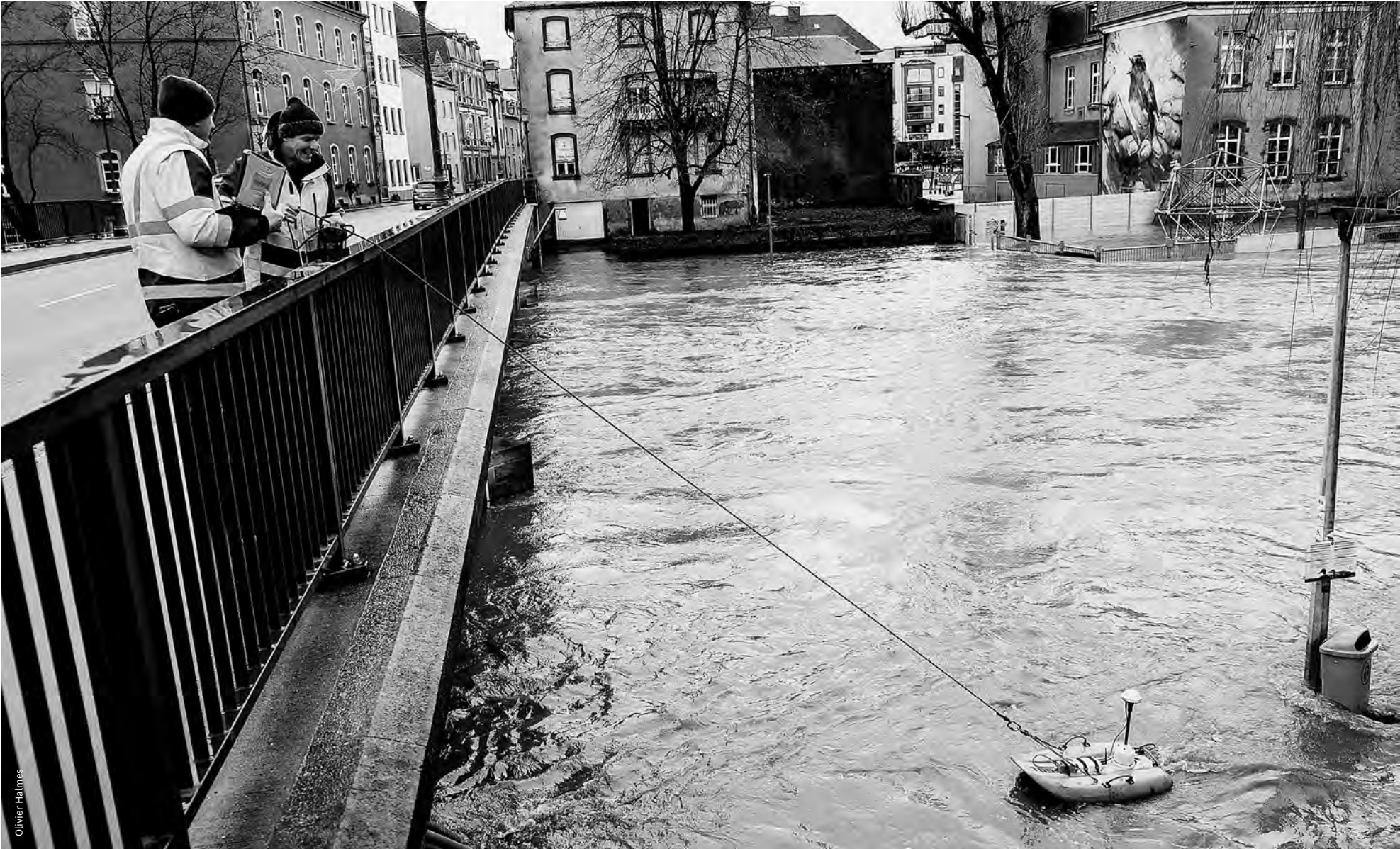
Mitarbeiter des Wasserwirtschaftsamts messen in der Hochwasser führenden Alzette in Ettelbrück die Strömungsgeschwindigkeit. Der Pegelstand der Alzette ging am Donnerstag wieder zurück
